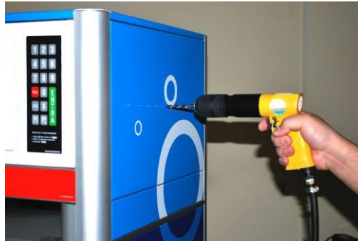
Figura 1 - Furo de 6 mm com furadeira Pneumática
