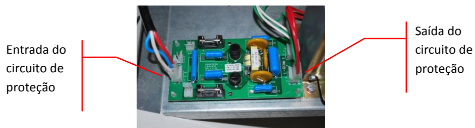
Figura 26 - Circuito de proteção.
