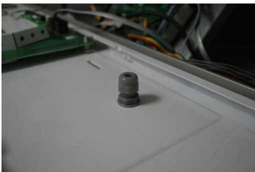
Figura 17 - Colocação do prensa cabo na chapa interna.
