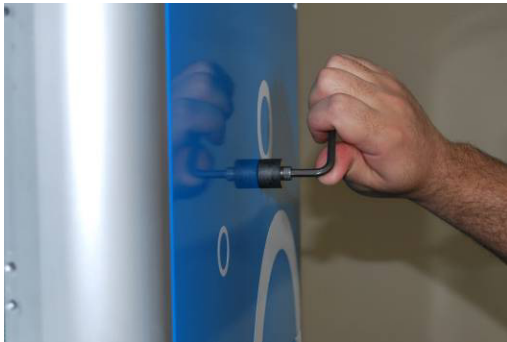
Figura 6 - Realizando o furo
