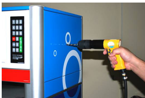
Figura 1 - Furo de 6 mm com furadeira Pneumática
